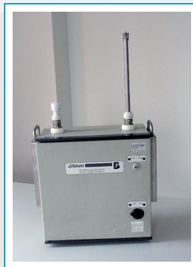
L' Environmental Dust Monitor 107 usato per la determinazione della concentrazione numerica delle particelle aerodisperse
