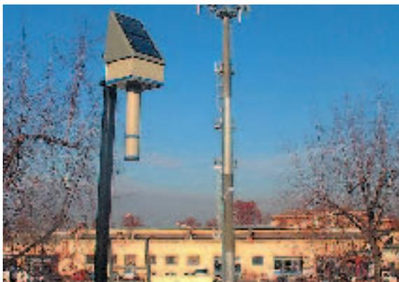
• Centralina per la misura in continuo del campo elettrico a radiofrequenza.
