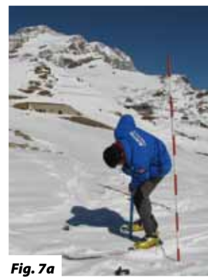
Figura 7. Fasi dei rilievi BTS (misura della temperatura del suolo, all'interfaccia neve-suolo). a) preparazione del foro di misura; b) inserimento del sensore nel perforo; c) raccolta dati (punto GPS, caratteristiche morfologiche e nivologiche del punto misura, misura della temperatura BTS).
