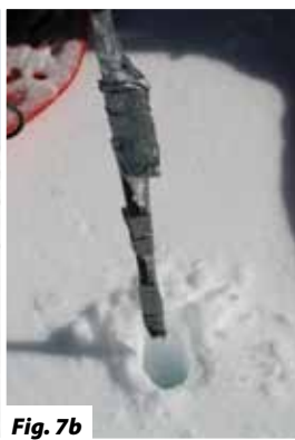
Figura 7. Fasi dei rilievi BTS (misura della temperatura del suolo, all'interfaccia neve-suolo). a) preparazione del foro di misura; b) inserimento del sensore nel perforo; c) raccolta dati (punto GPS, caratteristiche morfologiche e nivologiche del punto misura, misura della temperatura BTS).
