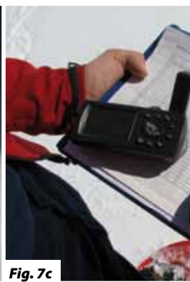
Figura 7. Fasi dei rilievi BTS (misura della temperatura del suolo, all'interfaccia neve-suolo). a) preparazione del foro di misura; b) inserimento del sensore nel perforo; c) raccolta dati (punto GPS, caratteristiche morfologiche e nivologiche del punto misura, misura della temperatura BTS).
