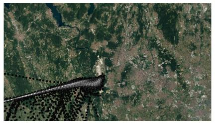
Figura 13, Mappa di concentrazione delle battute ADS-B per SID su FARAK 5Y
