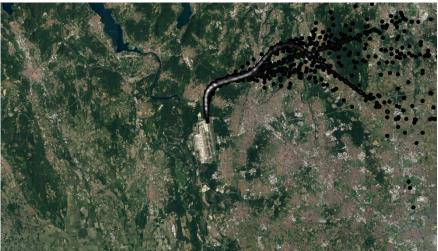
Figura 3, Mappa di concentrazione delle battute ADS-B per SID su track 069
